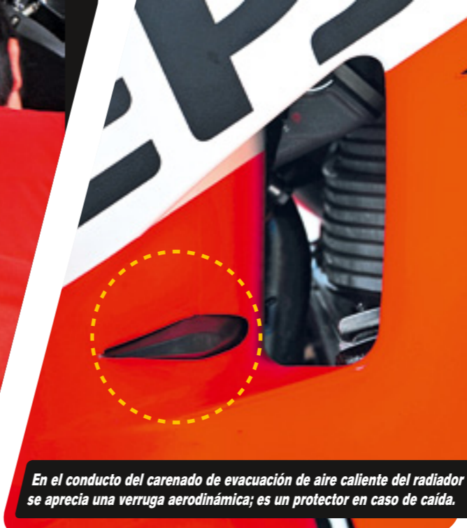
A través de las grandes aperturas laterales de evacuación de aire caliente del carenado, se aprecia claramente la culata del banco de cilindros delantero.
