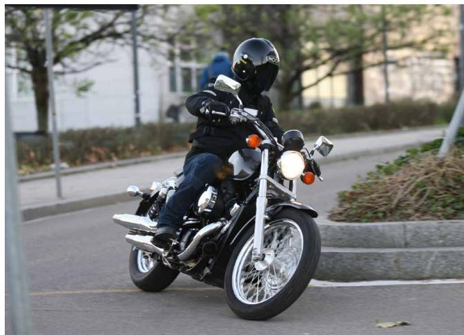
anche discretamente comoda. Alla faccia del doppio ammortizzatore, che solitamente garantisce un comfort solo sufficiente sullo sconnesso, la VT passa sul ciottolato più sgangherato con discreta naturalezza, anche grazie alle buone capacità incassatorie della forcella. La sella che sulle prime appare decisamente comoda, e funge da ulteriore filtro per le
